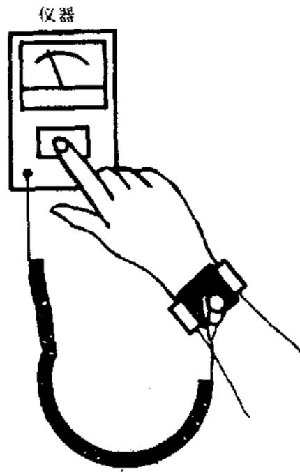
图 A7 腕带的对地电阻测量
