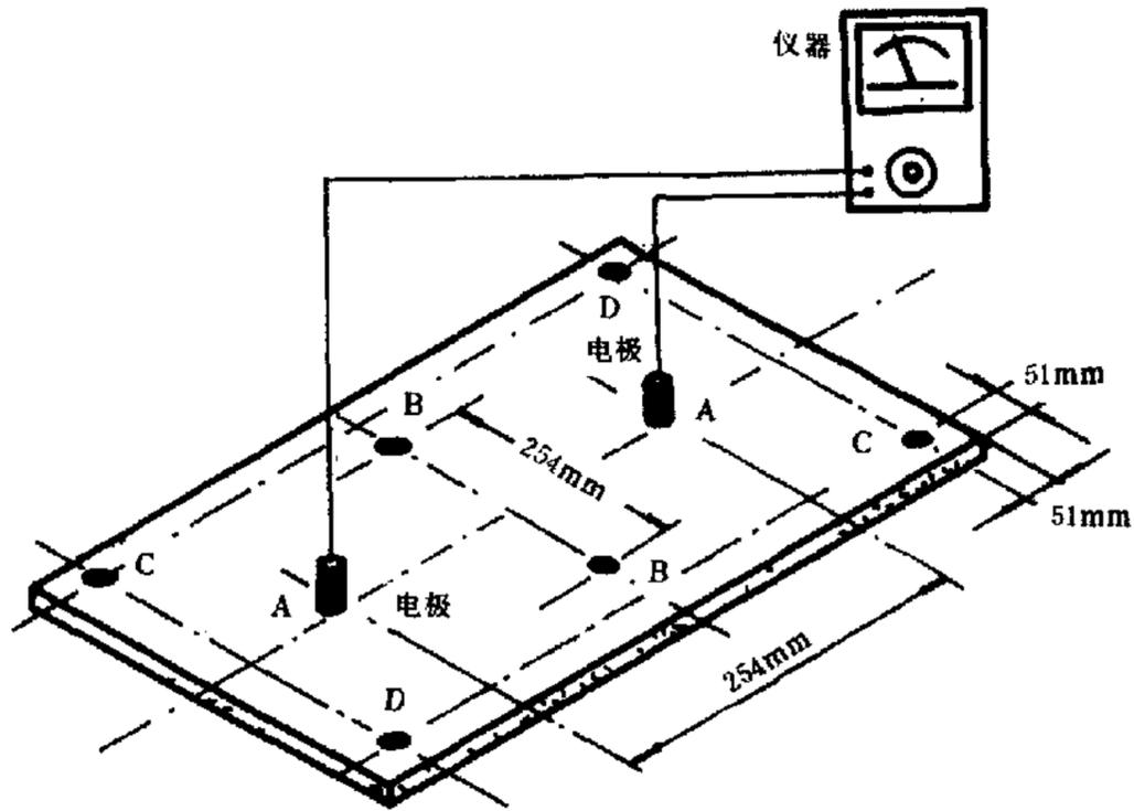
图 A2 工作面安装后的表面电阻测量
