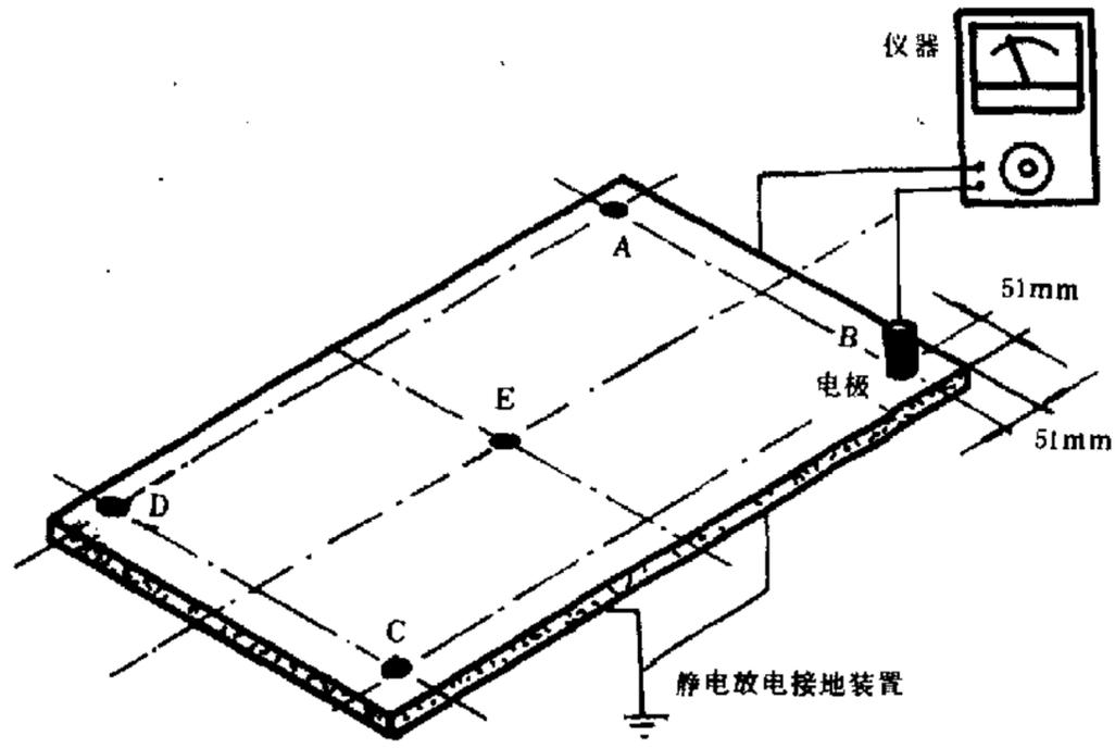
图 A1 工作面安装后的对地电阻测量
