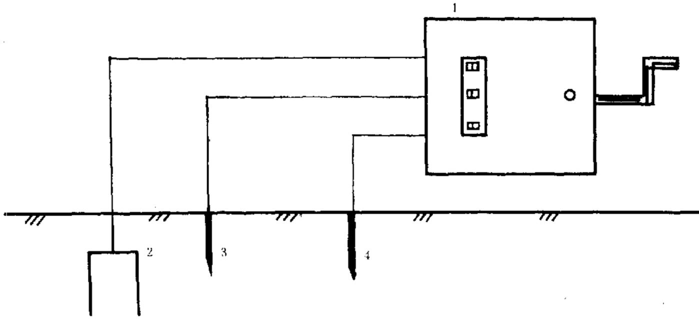
1. 接地电阻测试仪；2. 接地体；3. 电压极；4. 电流极
