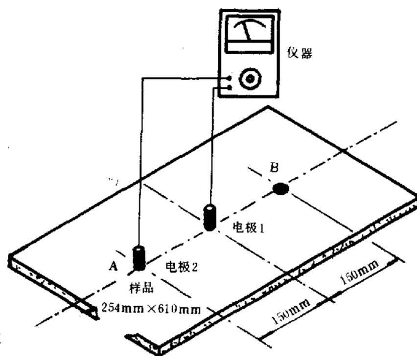
图 A4 地面安装后的表面电阻测量
