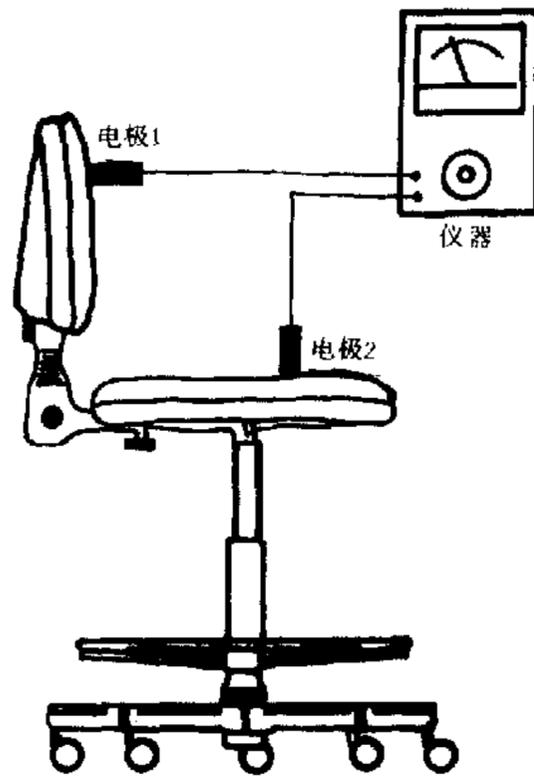
图 A6 椅子表面电阻测量
