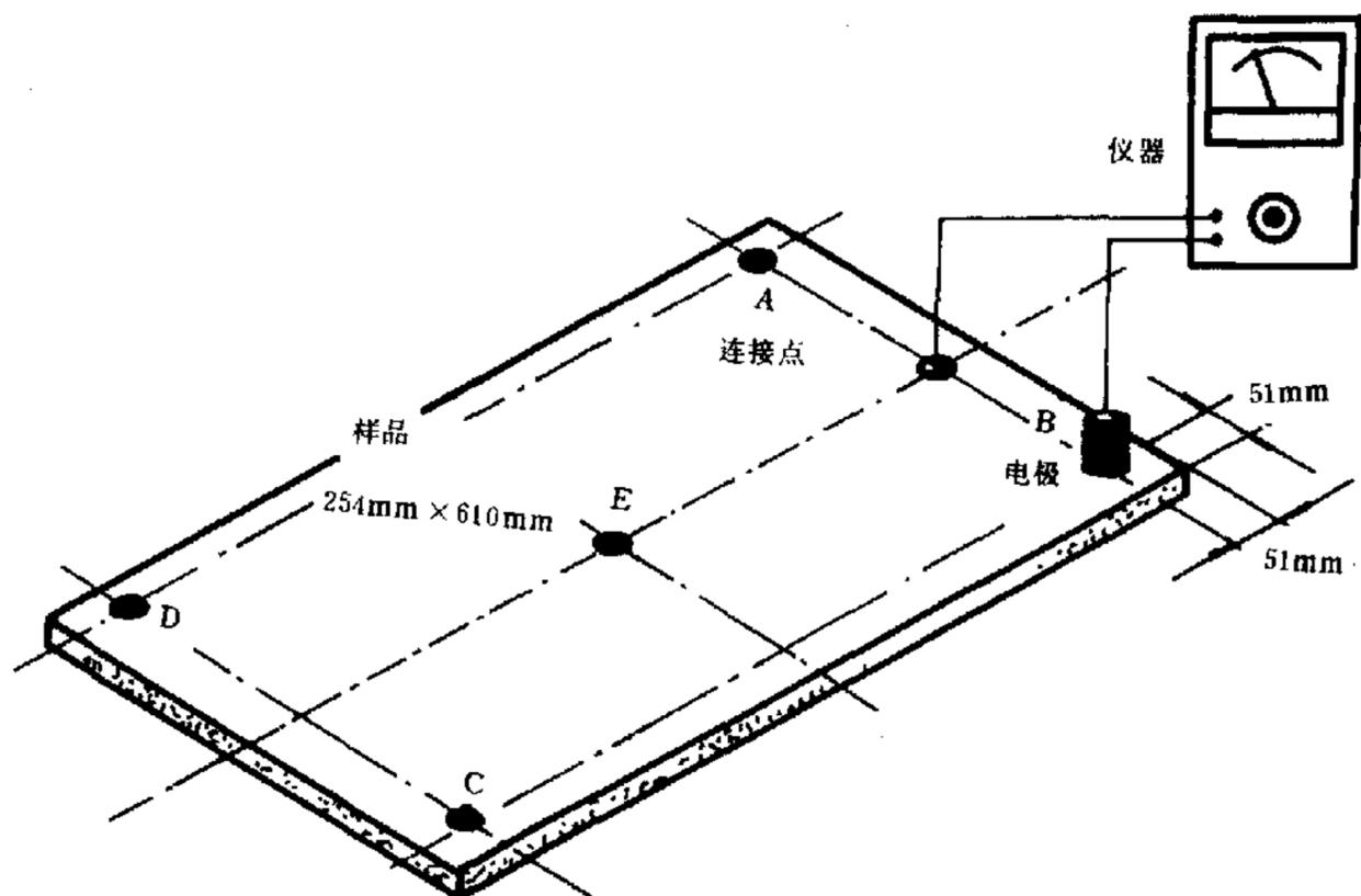
图 A3 地面安装后的对地电阻测量
